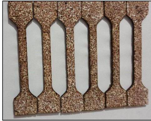
Figure 1. Epreuve du biomatériau selon la norme ASTM D638-0 pour les essais de traction.
